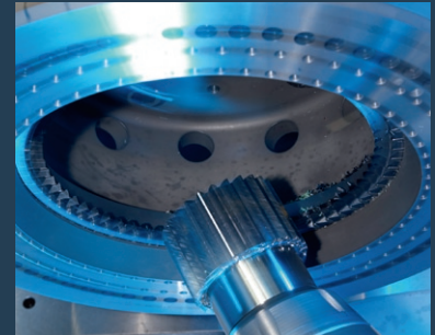
Wälzschälen einer Außenverzahnung
